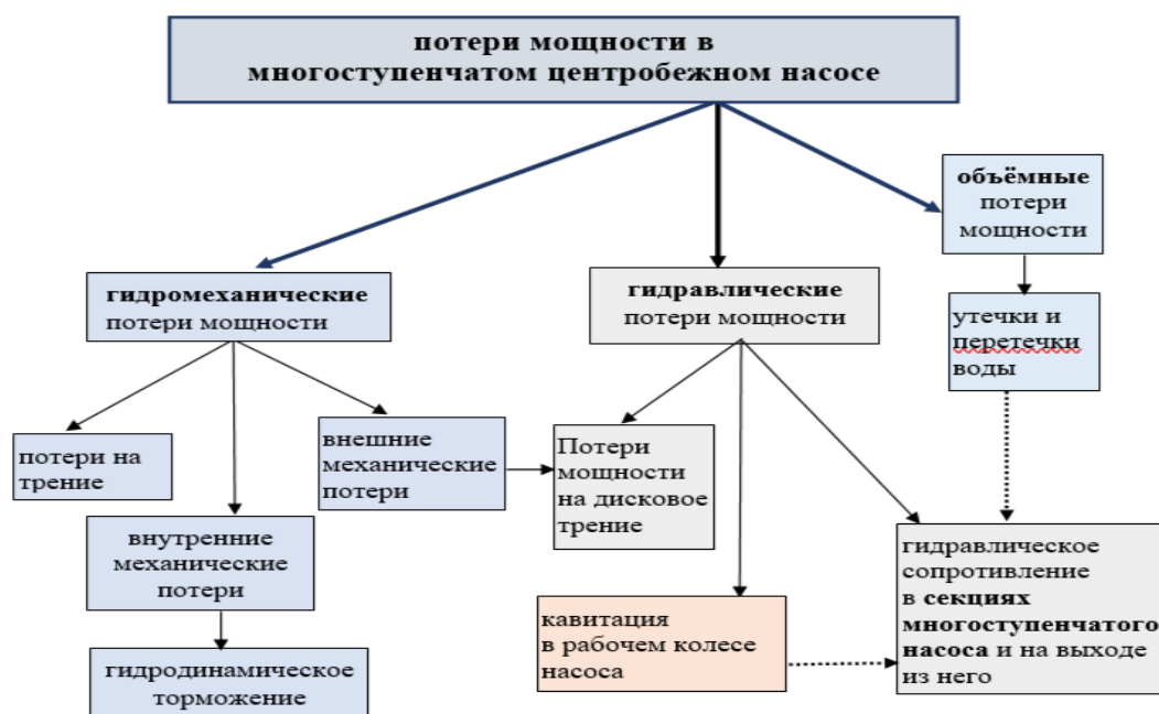
Рис. 3. Общие потери мощности погружного скважинного центробежного многоступенчатого насоса
