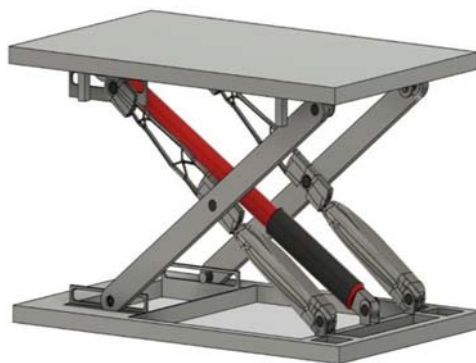
Рис. 1. Гидравлический ножничный подъемник [2]
