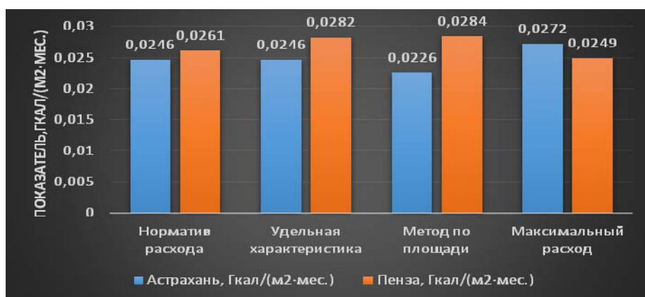
Рис. 1. Тепловая нагрузка на отопление
