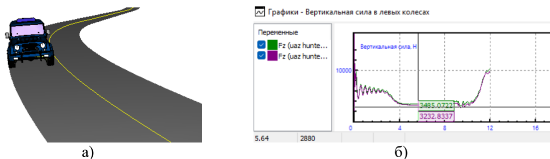
Рис. 1. Прохождение испытания «поворот» стандартного автомобиля на скорости 75 км/ч
